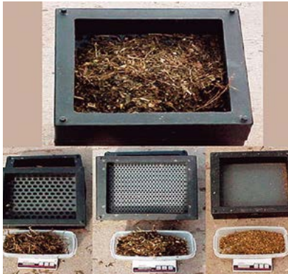
Figura 9. El separador Pennsylvania State Separator consiste en tres cajas y una fuente. Entre una caja y otra hay un tamiz con orificios que van disminuyendo de tamaño. El material que se desea examinar se coloca sobre el filtro superior y se agita de lado a lado 40 veces. Las cajas se rotan en un cuarto de giro cada cinco sacudidas. Las partículas más grandes sobre el tamiz superior flotarán en el rumen y requerirán más masticación. Las partículas que quedan en la caja central serán digeridas más lentamente. Y aquellas que quedan en la caja inferior serán fermentadas con rapidez y saldrán del rumen en poco tiempo. (Cortesía de R. Shaver.)
