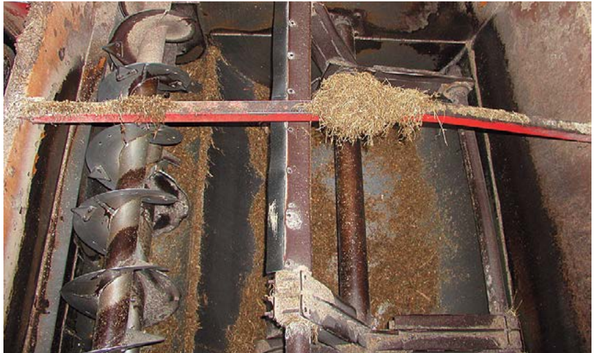
Figura 10. Hay muchos diseños de mezcladores mecánicos de alimento. En este caso, hay un remo que efectúa la mayor parte de la mezcla mientras que un sinfín entrega la mezcla final. La eficiencia de un mezclador depende de la constancia de mezcla y el seguimiento de las instrucciones por parte del operador. (Cortesía de K. Nordlund.)
