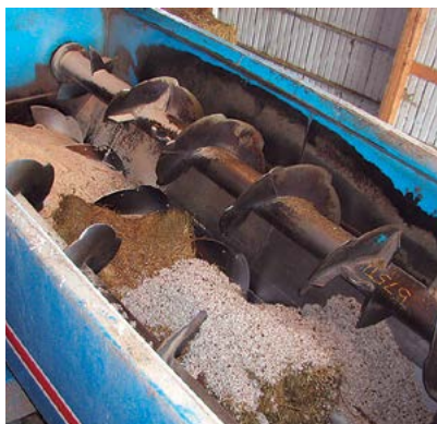
Figura 11. En este caso hay dos sinfín (uno a cada lado de la cuba) que efectúan la mezcla en direcciones opuestas, y un tercero en la base realiza la entrega de la mezcla resultante. (Cortesía de K. Nordlund.)
